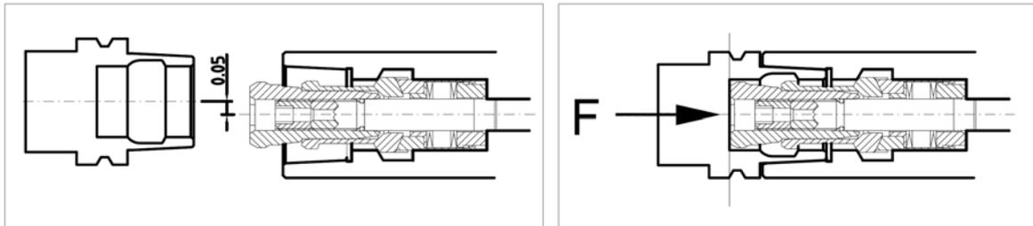
위와 같이 ATC 장치에 의해 TOOL HOLDER 삽입 시 TOOL HOLDER와 SPINDLE SHAFT의 편심량이 최대 0.05mm를 벗어나면 안됩니다. SPINDLE GIRPPER의 파손이 발생할 수 있습니다.
