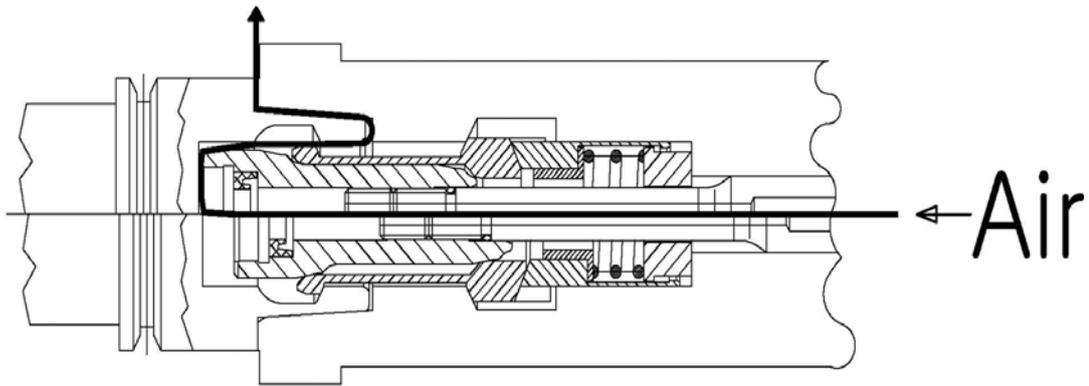
위 그림과 같이 SPINDLE 후방에서 압축 공기를 공급하여 TOOL HOLDER CLAMPING 전에 압축 공기를 몇 초간 공급하고 CLAMPING을 합니다. CLAMPING 시에는 반드시 CLEANING AIR를 잠근 후 CLAMPING을 하십시오.
